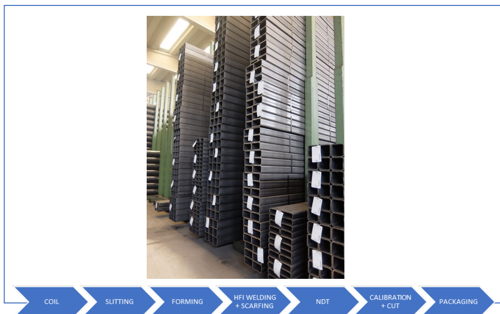
Figura 6 – Profili cavi, quadri e rettangoli a freddo (SGM) dell’azienda Arvedi Tubi Acciaio
