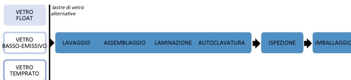
Fig. 3.1.4. Processo di produzione del vetro stratificato. Fonte: Elaborazione PoliMi.
